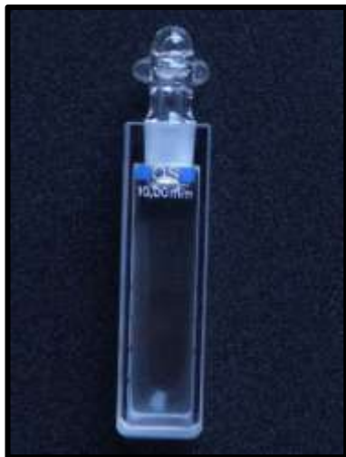
QS (Quartz suprasil) cuvettes
